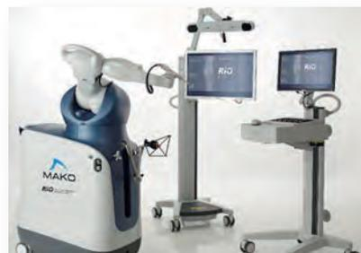
MAKO:ロボットアームを含む3つの機械からなる人工関節支援用手術ロボット
